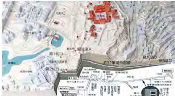
写真上：司令部壕全体模型。縮尺1:100 全長約1000m 写真左下：壕内部の模型 縮尺1:20 (天井高さ1.8m 幅1.5~2.4m) 写真右下：司令部壕位置模型 縮尺1:500 (地下15~35m、厚い琉球石灰岩層の下のクチャ層にあった壕)
