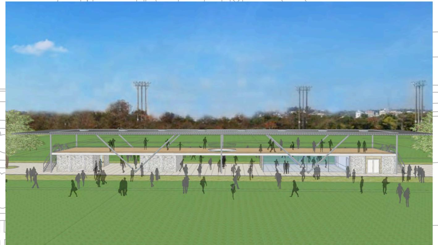
外壁面には県産材の琉球石灰岩を張る。ガラス張りの多目的室は建物を開放的に見せることで、大きな施設の圧迫感を和らげる。
