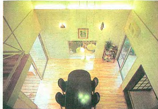
構造上不要な壁は取り除き、窓を設け明るく。正面のフィクス窓は照明付きのディスプレイ空間
